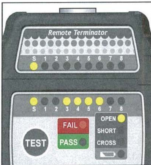
RJ45 STP 1,2 & 7,8 Open
